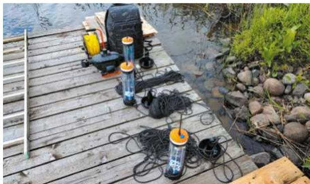
**Рис. 1.** Комплект оборудования WAYU перед установкой на водоеме (показаны три буй с якорями и якорными веревками) и микроТНПА «Трионикс-4М»
