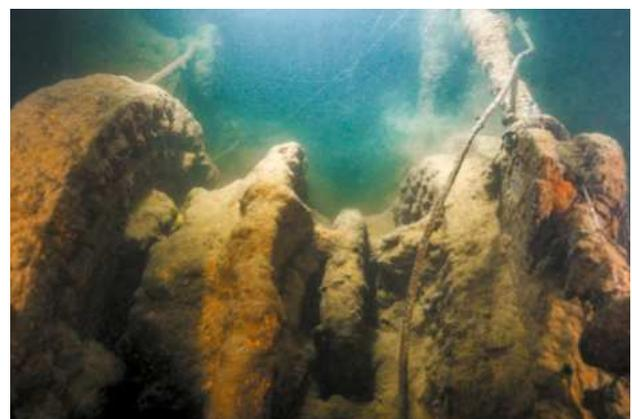
Рис. 6. Якорная лебедка в носовой части судна
