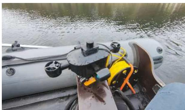
**Рис. 2.** МикроТНПА «Трионикс-4М» с пингером WAYU, установленным в верхней части ТНПА на специализированном кронштейне
