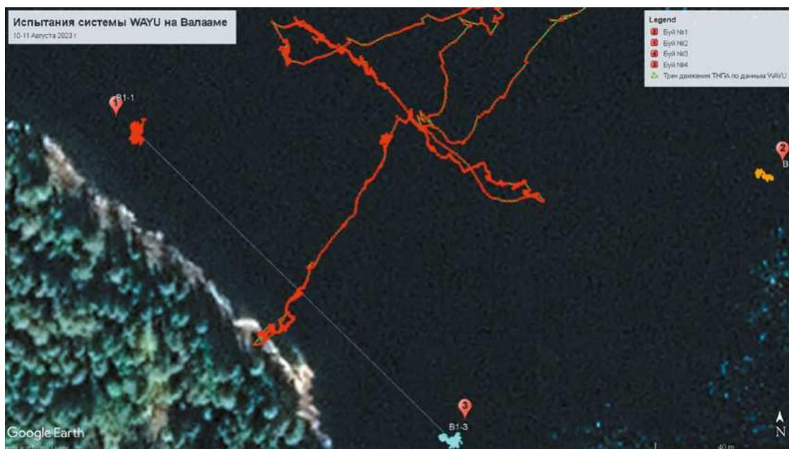
**Рис. 5.** Фрагмент трека. Большая Никоновская бухта, 10 августа 2023 г. Шкала масштаба 40 м. Показаны отдельные измерения местоположения и линия, соединяющая средние положения буев № 1 и № 3
