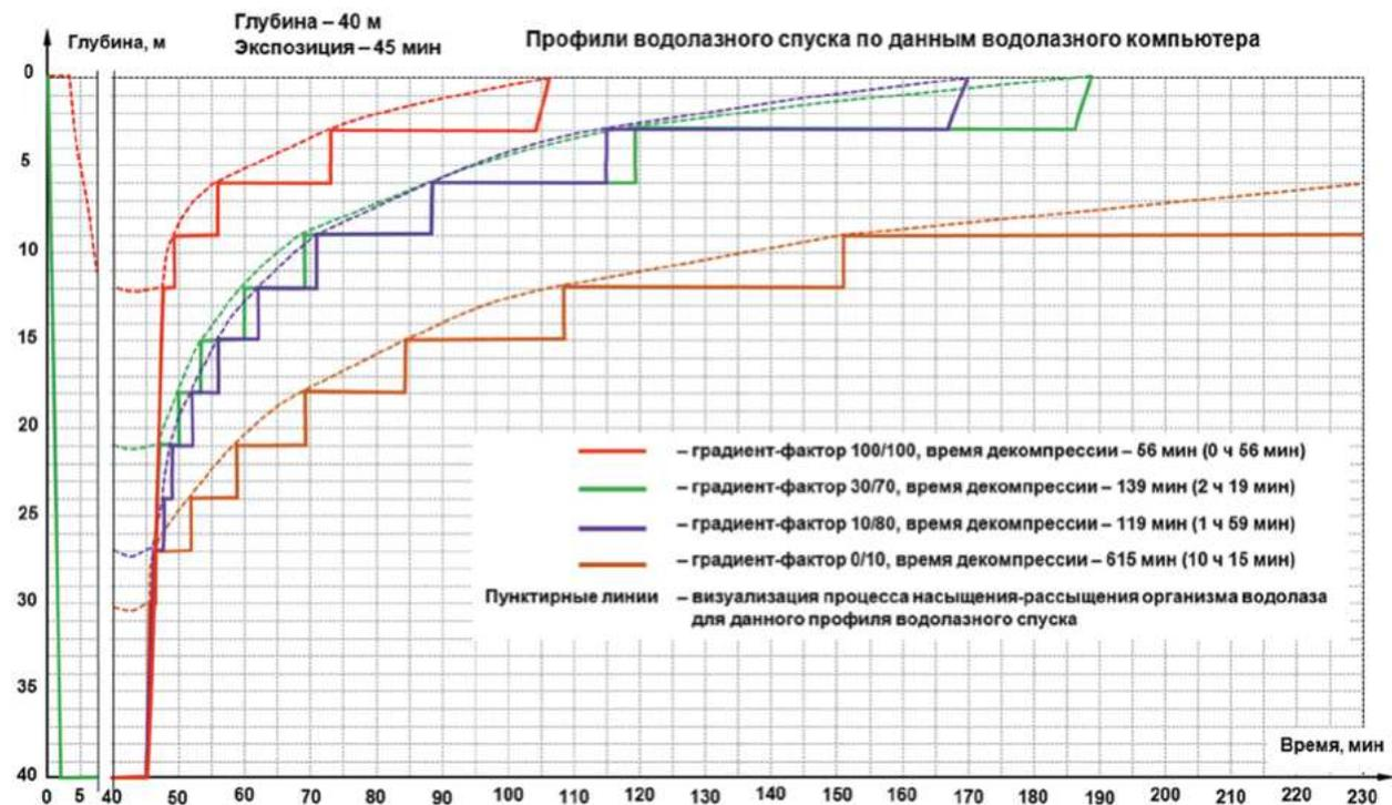
Рис. 3. Графики декомпрессии по данным водолазного компьютера
