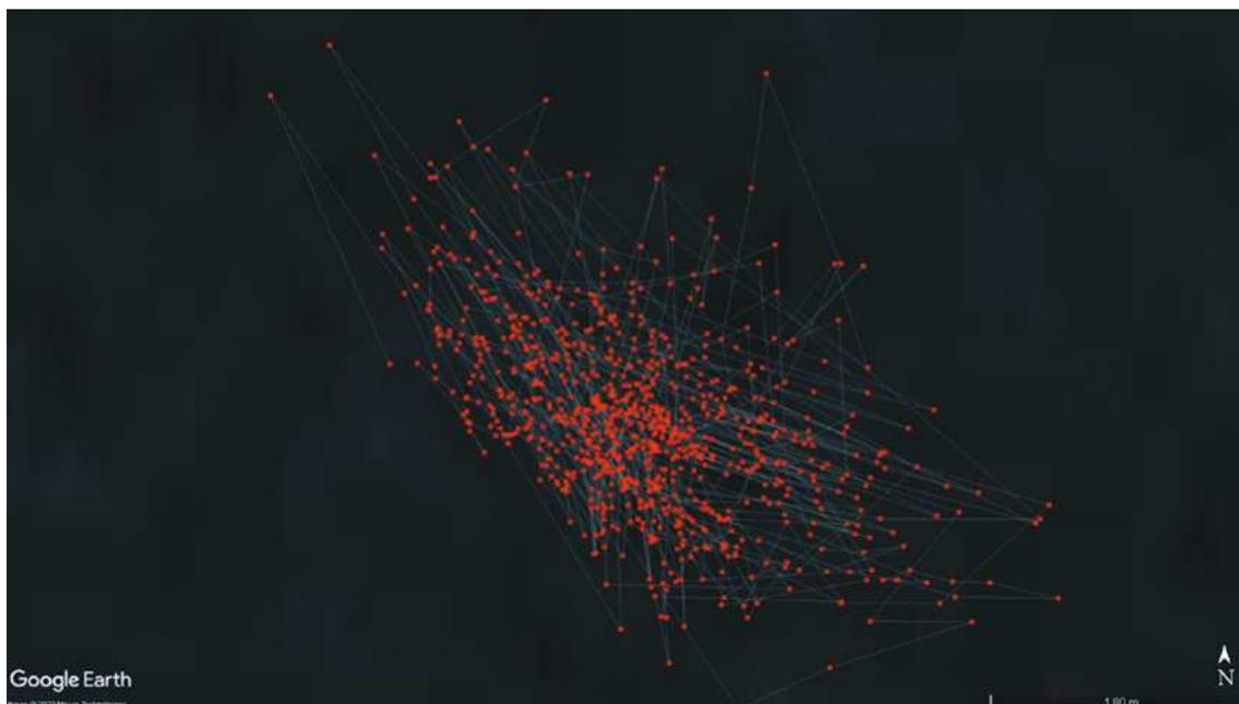
**Рис. 11.** Результаты определения местоположения неподвижного объекта (пингера) в течение 40 минут. Озеро Саперное, 10 октября 2023 г. Размер шкалы 1,8 м
