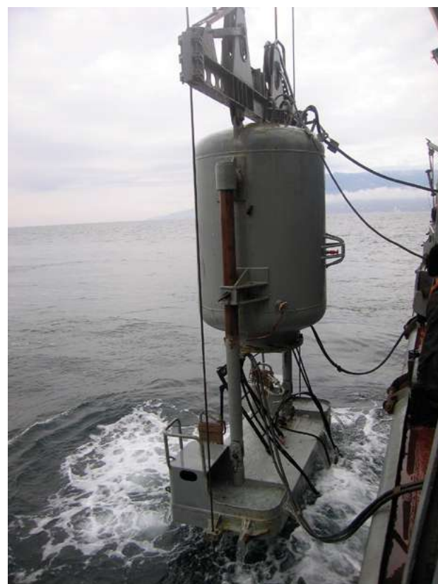
Рис. 2. Водолазный колокол для глубоководных водолазных спусков методом кратковременных погружений. Из архива ЦПИ РГО
