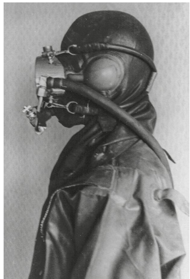
Рис. 7. Один из вариантов облегченного водолазного снаряжения (ОВС) на базе рейдовой маски ЭПРОНа и гидрокombineзона ТУ-1. Фото из собрания водолазного специалиста Ю. К. Павловского
