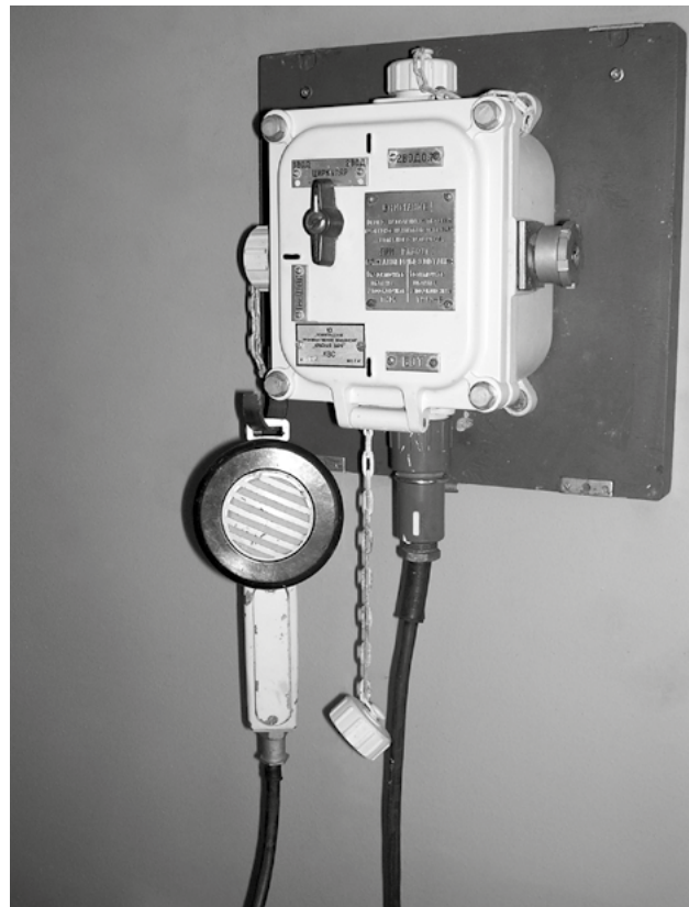
Рис. 19 а, б. Водолазные телефонные станции. Слева — телефонная станция КВЛ-36 завода им. А. А. Кулакова разработки 1936 г. Справа — водолазная комбинированная телефонная станция ВК-1 разработки конца 1950-х годов
