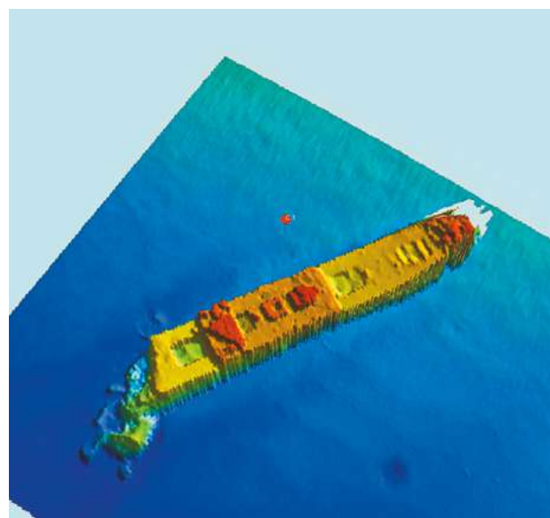
Рис. 12 б. Пароход «Друмлойст» на сонограмме, полученной с помощью многолучевого эхолота
