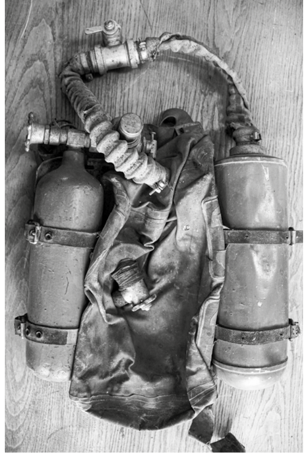
Рис. 14 а, б. Дыхательный аппарат регенеративного типа ИПА-2. Аппарат имеет принципиально новую компоновку по отношению к аппаратам серии Э, и эта компоновка дыхательных аппаратов регенеративного типа сохранилась до конца 1950-х годов
