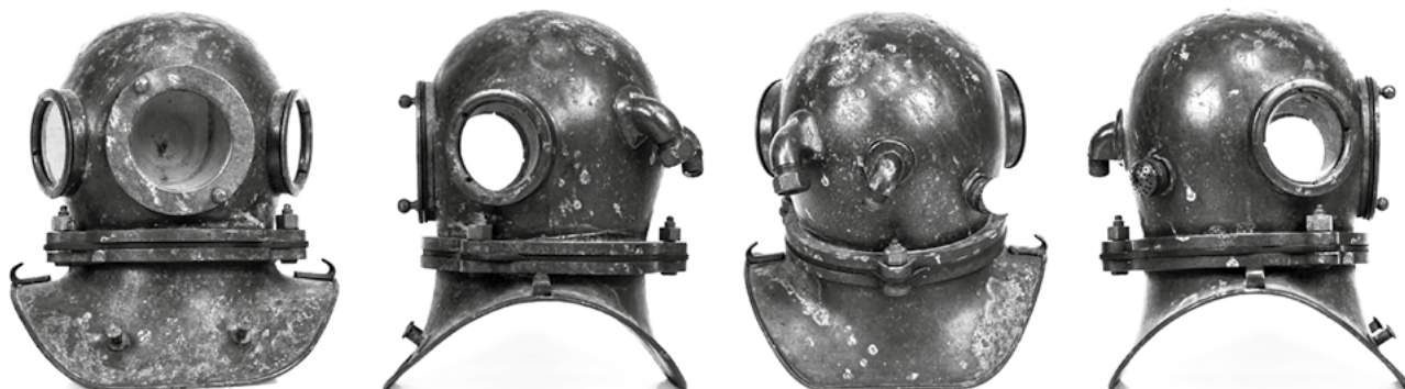
Рис. 17. Шлем трехболтового вентилируемого водолазного снаряжения конструкции и производства ЭПРОНа. Котелок шлема унифицирован с котелками шлемов двенадцатиболтового снаряжения
