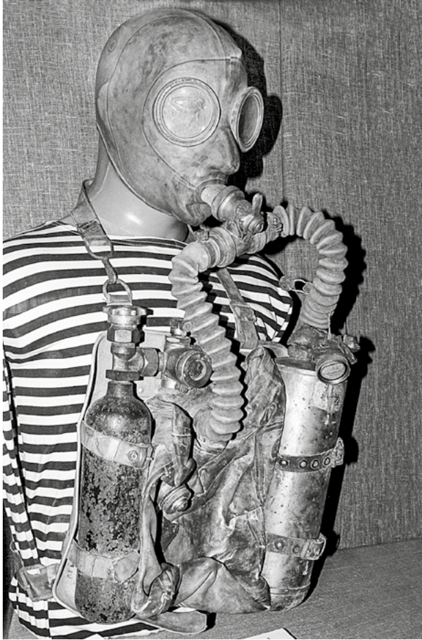
Рис. 14 а, б. Дыхательный аппарат регенеративного типа ИПА-2. Аппарат имеет принципиально новую компоновку по отношению к аппаратам серии Э, и эта компоновка дыхательных аппаратов регенеративного типа сохранилась до конца 1950-х годов
