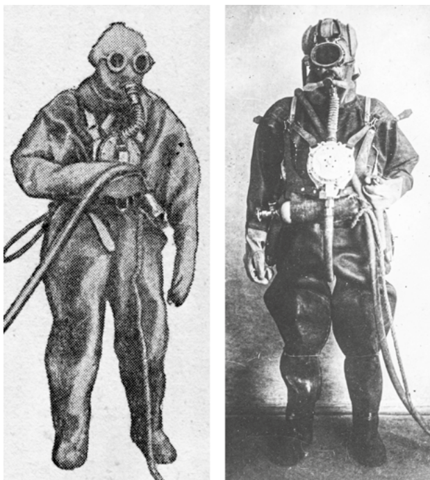
Рис. 10. Два варианта облегченного водолазного снаряжения АПС, созданные в первые послевоенные годы. Возможно, это экспериментальные модели на разных этапах создания одного и того же снаряжения или разработки разных коллективов, что более вероятно
