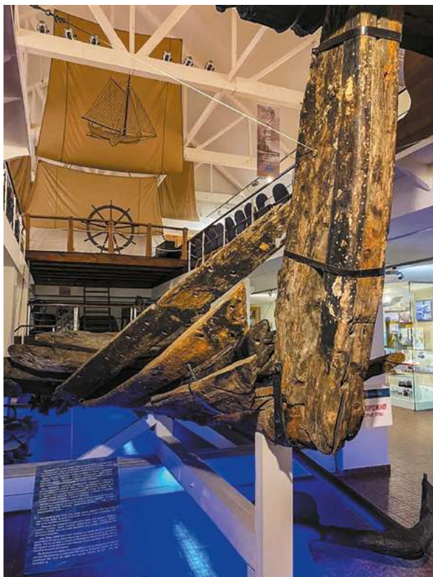
Рис. 2 б. Форштевень одномачтового грузового корабля XIX в., найденного в янтарном карьере в пос. Янтарный, находящегося в экспозиции Музея Мирового океана. 2023 г.
